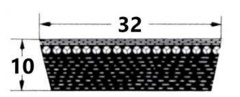
Szerokość pasa [mm] = 32 Wysokość pasa [mm] = 10 Długość wewnętrzna Li [mm] = 850 Kąt [°] = 27
