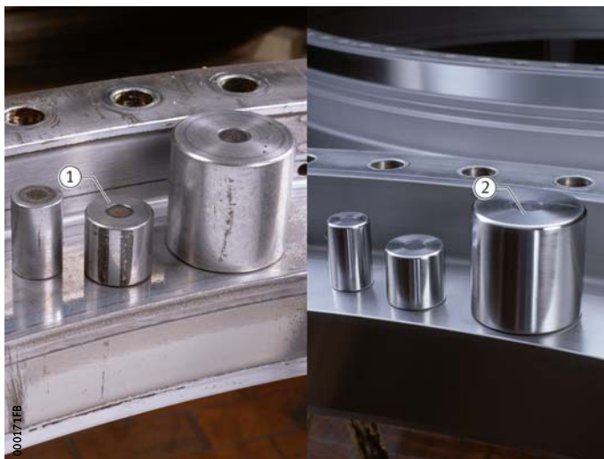
Ilustr. 7 Bieżnia i waleczki łożysk tocznych przed i po regeneracji
