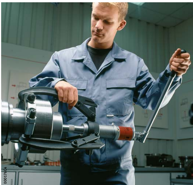
Ilustr. 1 Demontaż łożyska za pomocą ściągacza hydraulicznego
