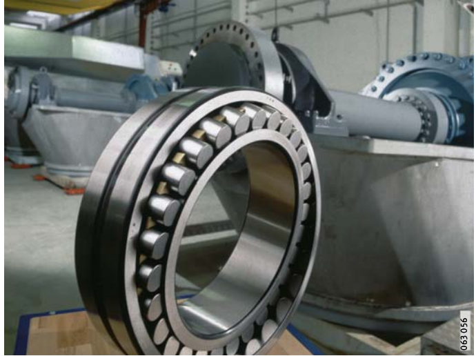
Ilustr. 7 Nastawne kątowno łożyska barytkowe FAG do łożyskowania wirników
