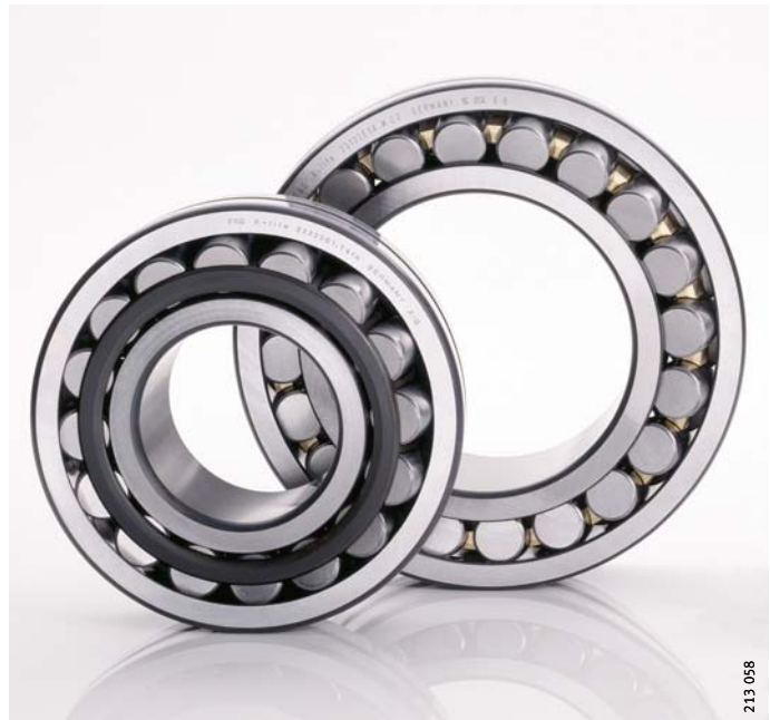
Ilustr. 11 Łożyska barytkowe E1 klasy jakości X-life. O podwyższonej nośności, niskiej temperaturze roboczej i największej trwałości użytkowej
