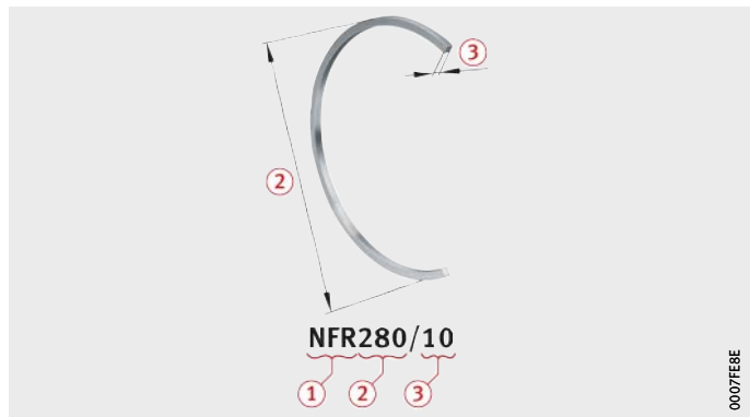
Bild 18 Aufbau der Kurzzeichen von Festringen, Beispiel
